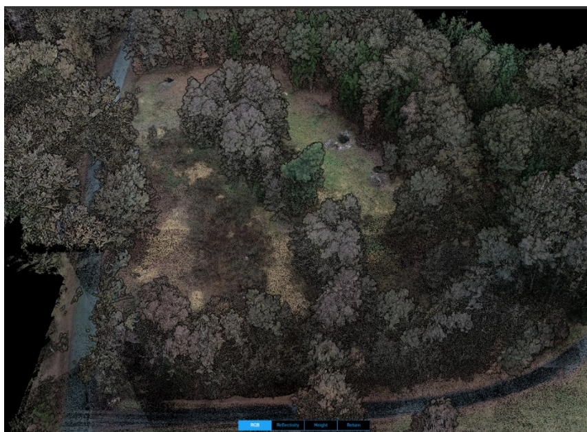
Obr. 2.1 Vizualizace zpracovaného bodového mračna v programu DJI Terra – RGB spektrum
