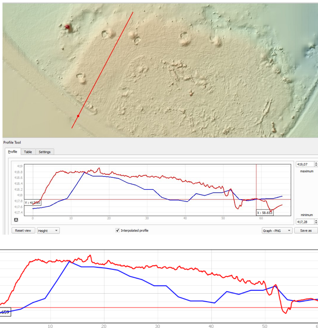
Obr. 4.1 Vizualizace profilu č. 1 v DEM z 20. 12. 2023 na podkladu interpolované referenční vrstvy DMR 5G modelu ČR z roku 2011.
