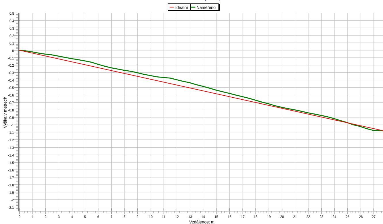
Grafické znázornění spádu potrubí
