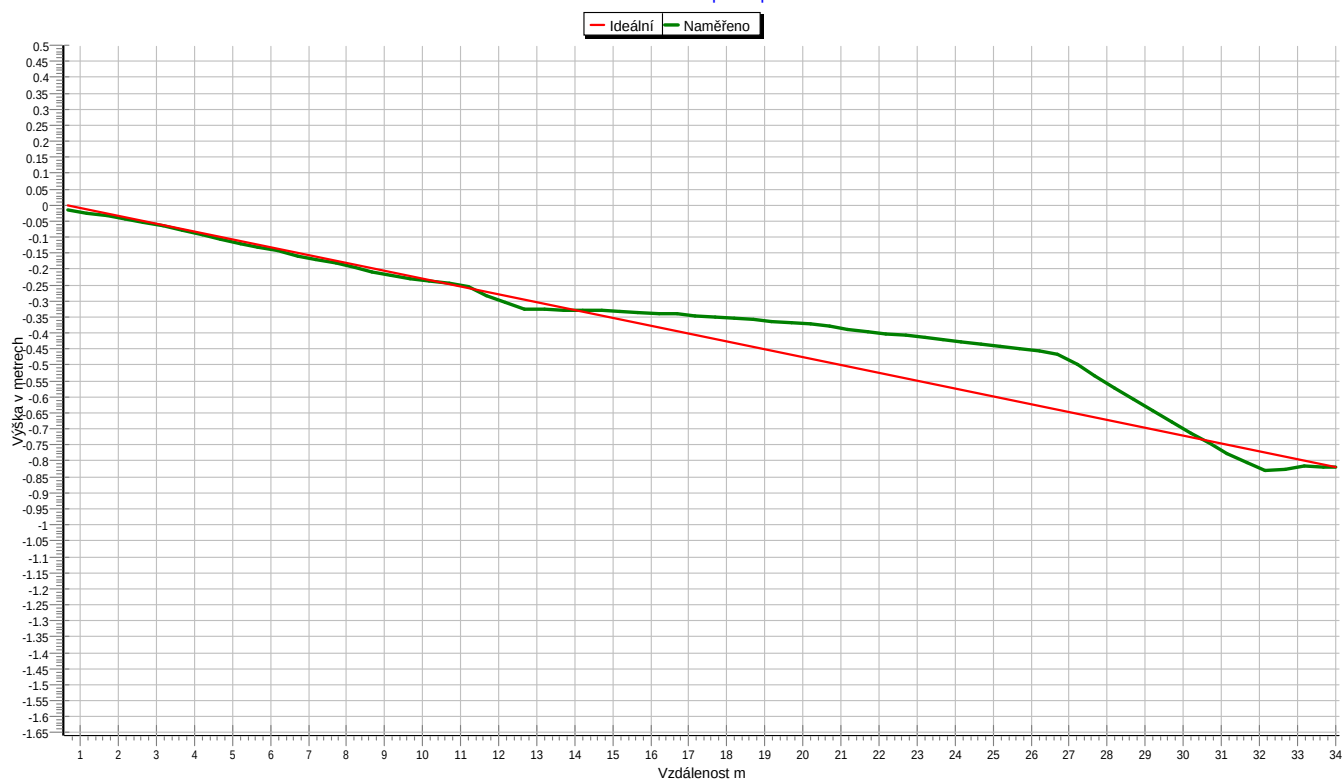
Grafické znázornění spádu potrubí
